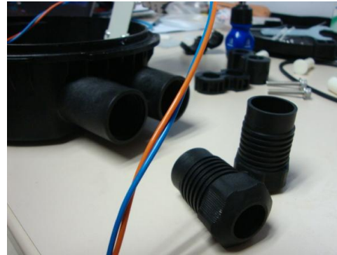
4.Puertos individuales. Vista de los puertos individuales junto sus tubos de sujeción. Este puerto servirá para la introducción de los cables de unión y cable de ramificación según configuración.
