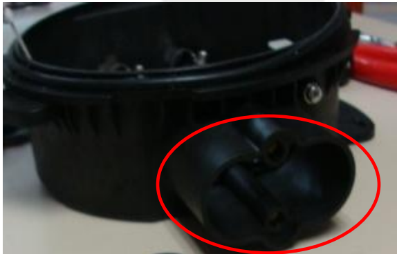
1.Introduciremos el cable troncal dentro del puerto dual del cierre ya sin ningún tipo de arandela o método de sujeción.
