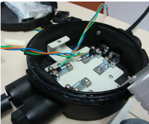
1. Con los dos cable de unión insertados procederemos a acomodar los tubos dentro del cierre.
