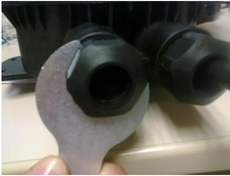
3.Puertos individuales. Extraemos los tubos de sujeción de los puertos individuales del cierre con la ayuda de la llave hexagonal
