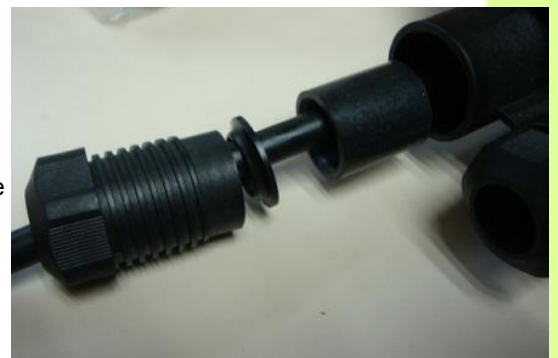
1. Antes de introducir un cable secundario o de unión tenemos que cercionarnos de introducir el tubo de presión, la arandela de plástico \phi 4 y el empaque de sellado correspondiente al diámetro del cable (VER ANEXO 1)
