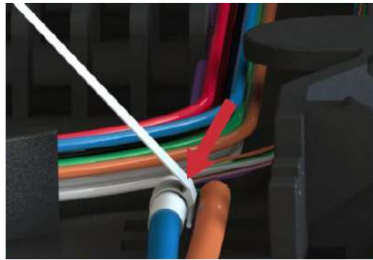
21. Fijar con cinchos a la charola el tubo holgado en conjunto con el tubo transportador.
