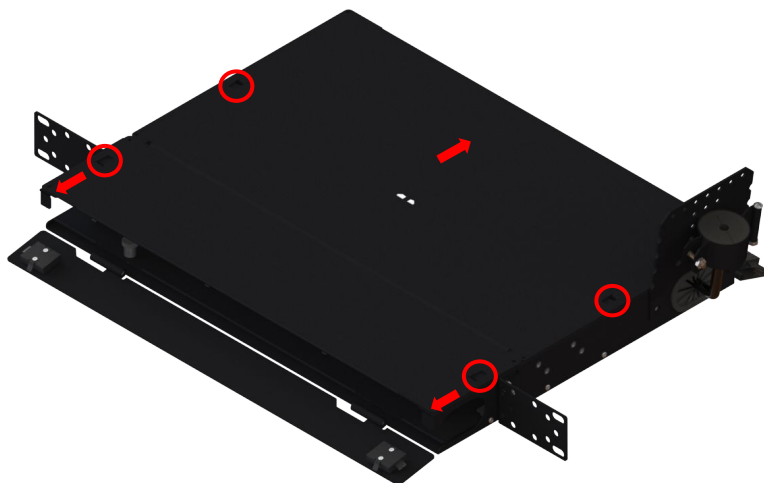
Fig. 7 Método de abertura del distribuidor
