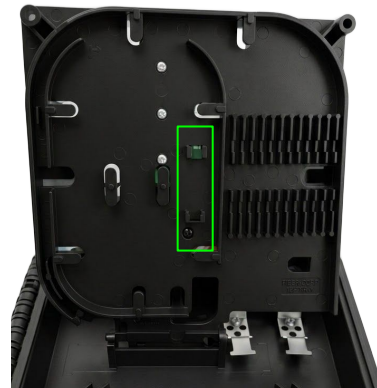
Fig. 2 : Zona de alojamiento del splitter y ruteo del cable de entrada del splitter.
